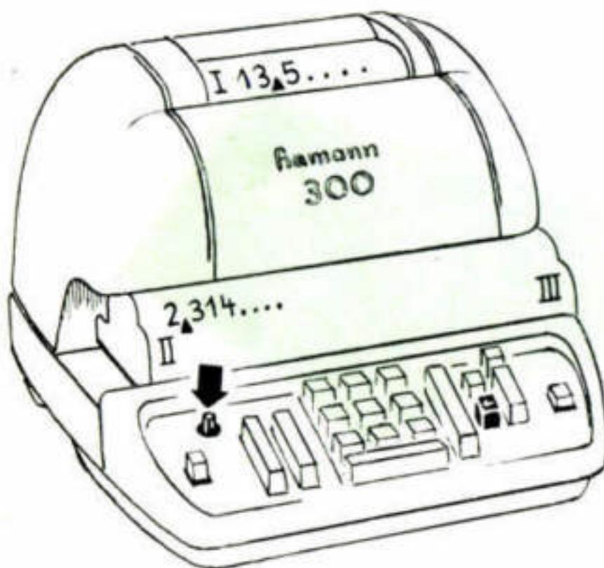
Wenn die Genauigkeit an einer bestimmten Stelle für Sie ausreicht, unterbrechen Sie die Division dort durch einen kurzen Druck auf meine Divisionsstoptaste
