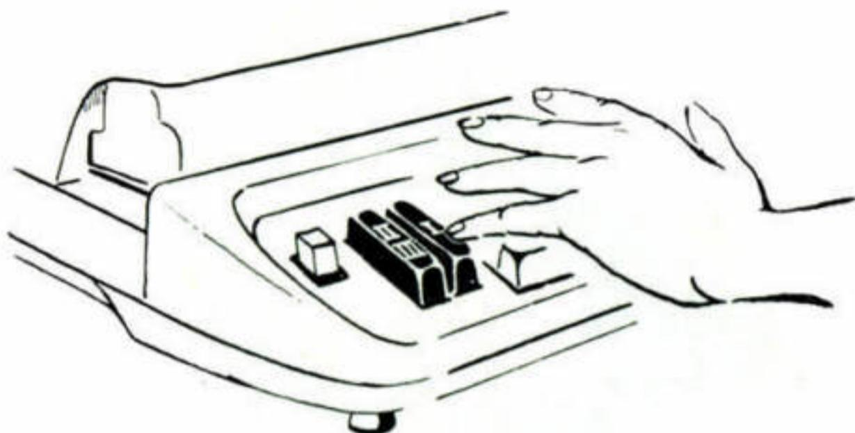
... löschen Sie alle Werte! Drücken Sie einfach auf die mit I und II/III bezeichneten Löschtasten. Wenn für die Aufgabe nötig (ich erkläre Ihnen das noch eingehender bei den entsprechenden Rechenarten), bringen Sie den Schlitten in die gewünschte Stellung. Dafür genügt ein Druck auf die Transporttasten. Bei leichtem Anschlag wird der Schlitten um jeweils eine Stelle transportiert, bei stärkerem Durchdrücken um beliebig viele Stellen.
