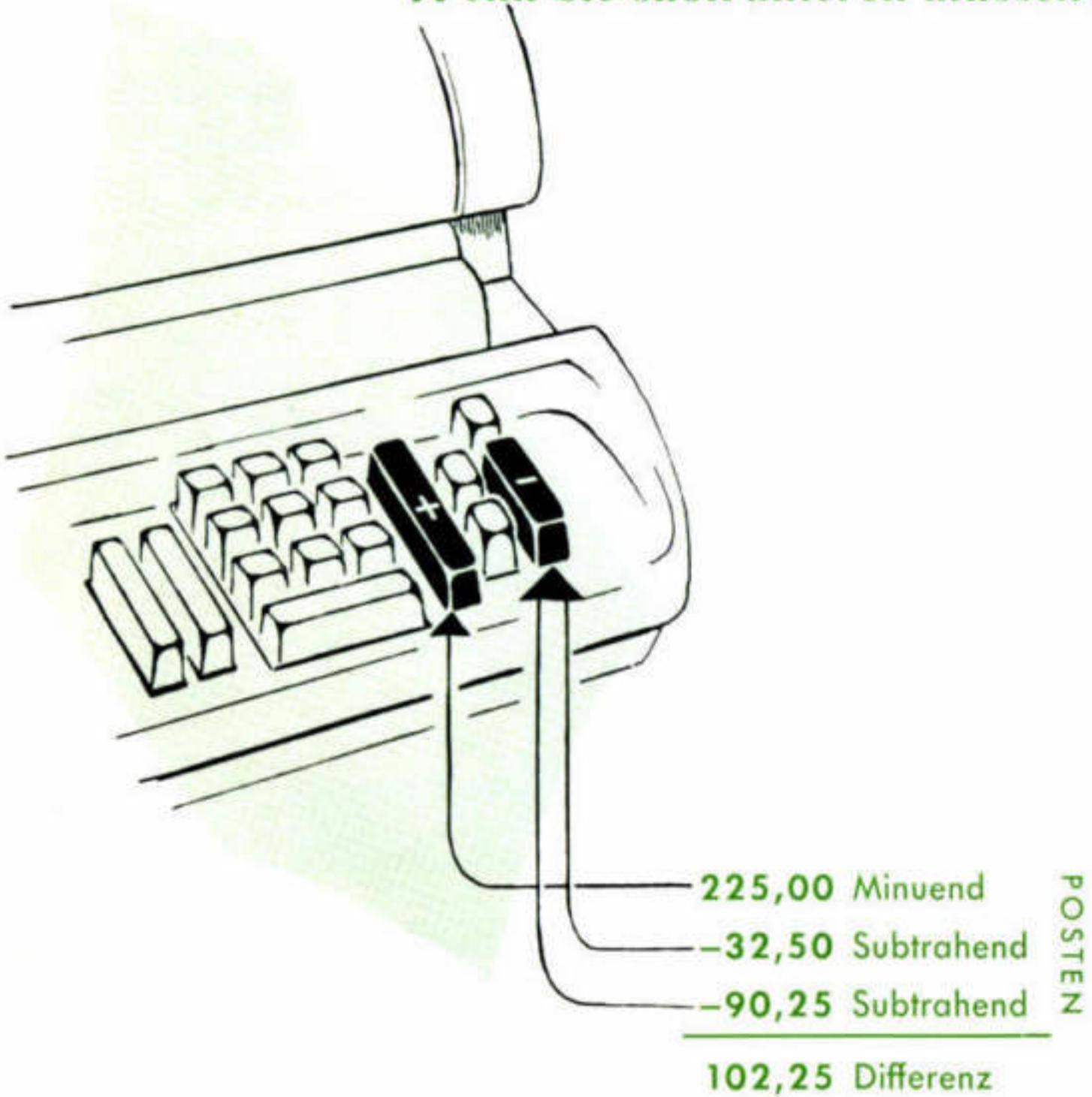
... tasten Sie die Posten genau so wie bei der Addition nacheinander ein. Der Minuend wird durch die Plustaste übertragen, der Subtrahend durch die Minustaste. Im R-Werk erscheint nach dem letzten Tastendruck die Differenz als Ergebnis.
